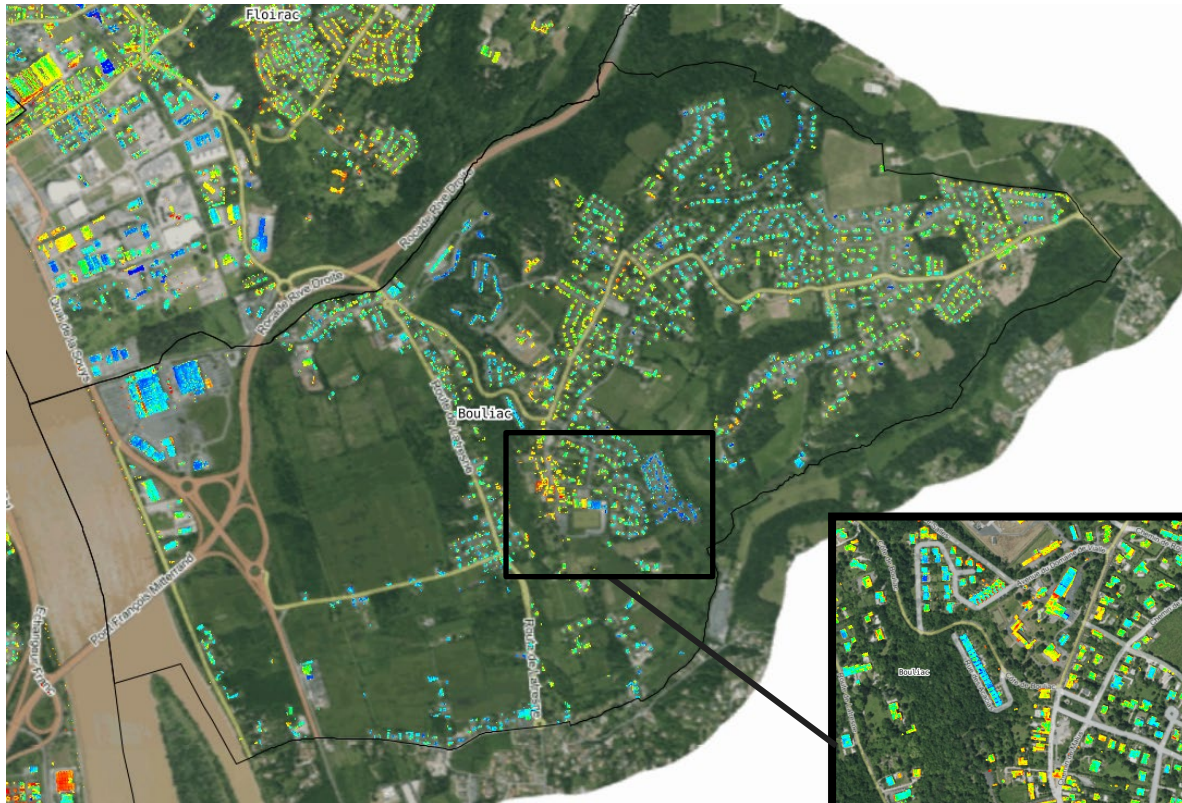
Thermographie aérienne acquise dans les nuits des 15 au 16 novembre et 16 au 17 novembre 2017, 8 au 9 février et 22 au 23 février 2018 | © Bordeaux Métropole/MaRénov Source : geo.bordeaux-metropole.fr/thermographie/
